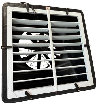
Les ventilateurs de série AVI-ECI sont munis de moteurs synchrones à aimants permanents avec onduleur (*drive ou inverter*) intégré. Ces moteurs garantissent d'importantes économies d'énergie à vitesse variable et ont une efficacité au-delà des valeurs IE5. Ils sont munis d'une protection IP65 et pilotés en MODBUS RS485 ou en 0-10 volts pour gérer la vitesse variable.
