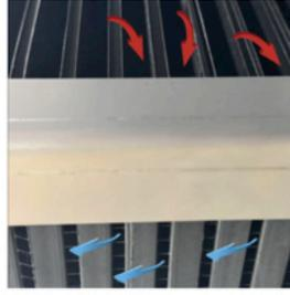
Le bloc est constitué de centaines de petits tubes qui forment les voies de circulation de l'air. La voie d'air chaud et humide est verticale, tandis que la voie d'air frais est horizontale. L'essentiel est que les deux voies partagent une paroi commune.
